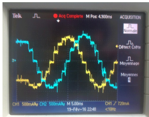
Mesures de courant dans les deux phases en mode quart de pas
